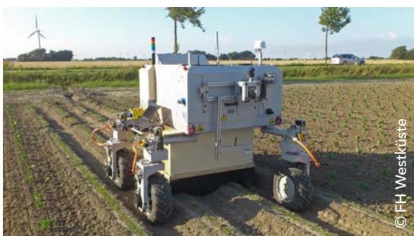
Einsatz des BoniRobs zur Beikrautregulierung bei Biomöhren auf den Feldern des Westhofs.
